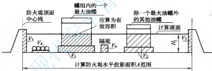
图 1 防火堤有效容积计算示意
