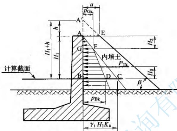
图 5.2.3 内培土压力计算示意图
