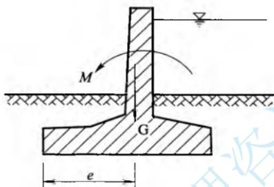
图 5.4.3 防火堤抗倾覆验算简图
