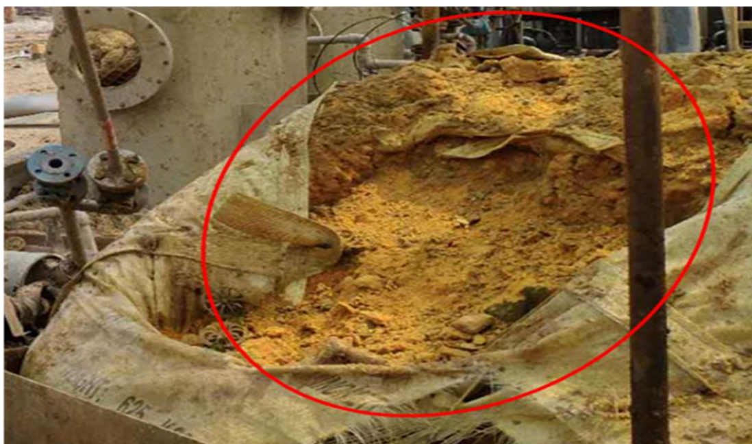
图 2 事故现场发现的硝化废料
