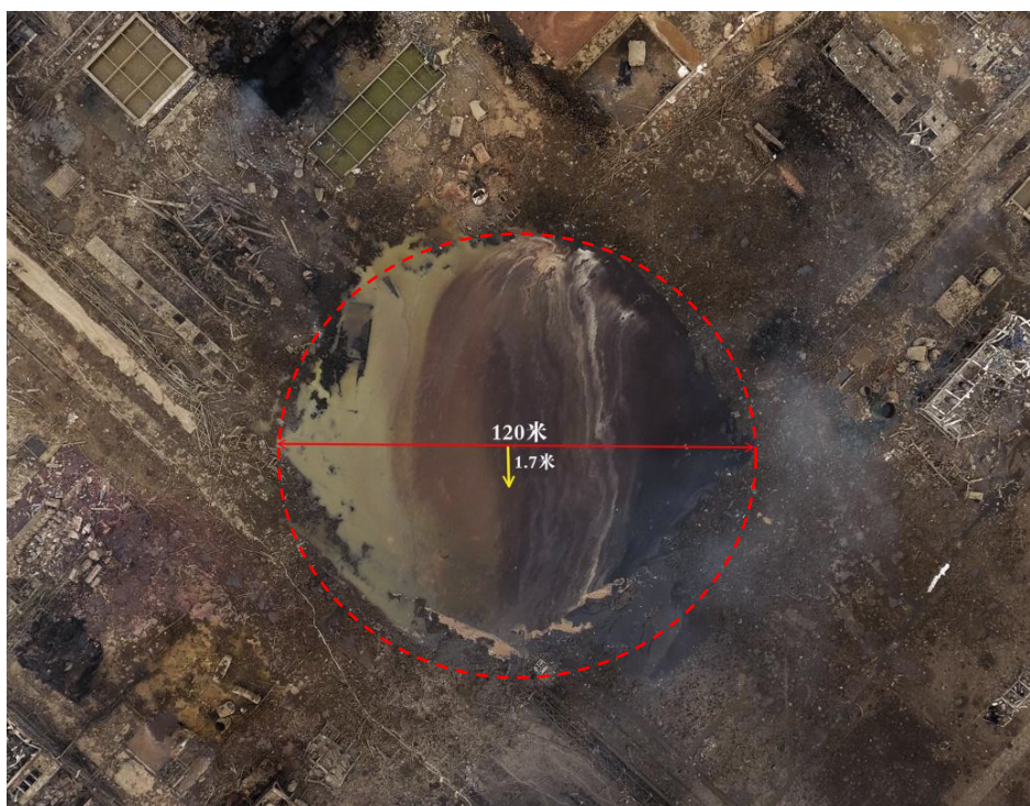
图 7 爆炸后积水坑示意
