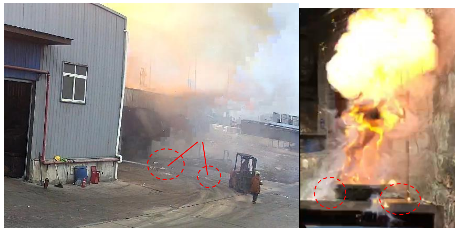
图3 硝化废料固体颗粒燃烧物溅射对比
